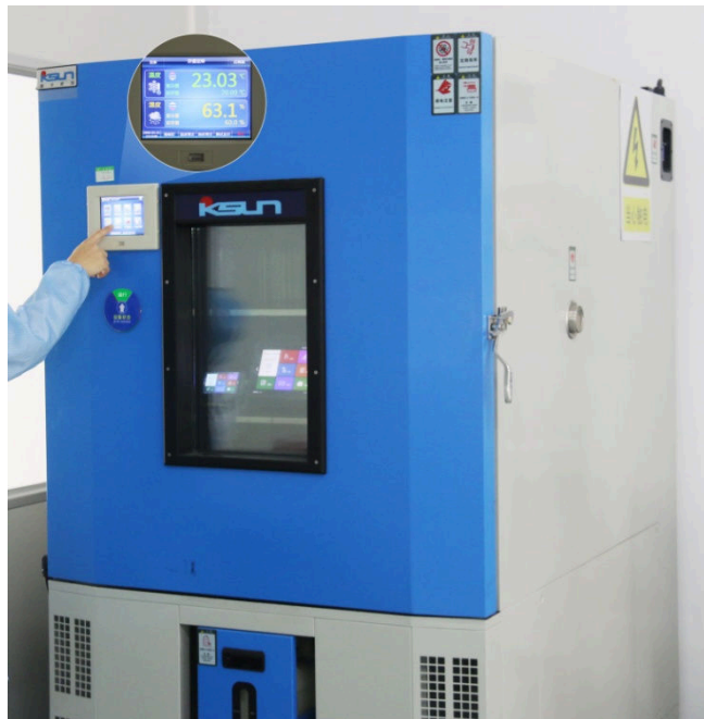
图 3-3 高低温老化测试图
