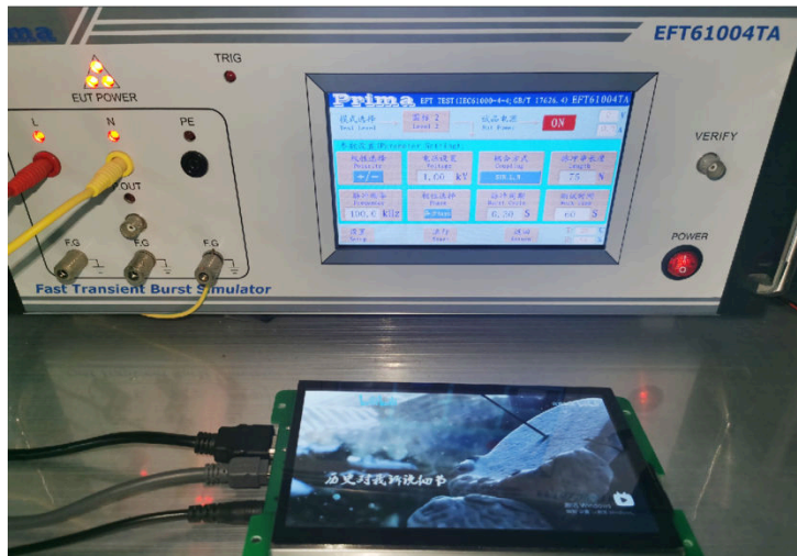
图 3-4 群脉冲测试图
